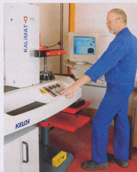
Der Bediener am Einstellgerät (rechts) bekommt die Voreinstellliste von TDM angezeigt (links); Schnittstellen sorgen für den reibungslosen Datentransfer zwischen Maschine, Voreinstellgerät und TDM. Die Vorteile: Automatische Übernahme der Werkzeug- und Werkzeughaltergeometrie sowie sämtlicher Schnittwerte als auch zusätzlicher Informationen (z.B. zu Kühlmitteln) aus TDM.
